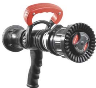
Berlin Force: Das Strahlrohr mit automatischer Druckregulierung, ist mit einem flash-over geeigneten Positionsrasterung für den Sprühstrahl ausgestattet.
