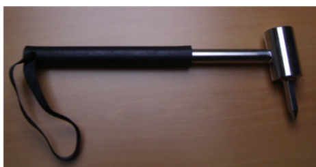
Marteau de pré-perçage (poids : 2.5kg / longueur : 50cm)
